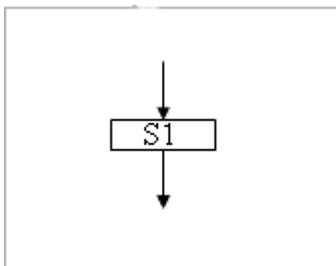
Данный блок имеет *один вход* и *один выход*. Из простых команд и проверки условий образуются составные команды, имеющие более сложную структуру и тоже *один вход* и *один выход*.
