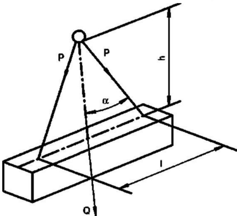
Рисунок 9.1 – Схема к расчету двухветвевое стропа
