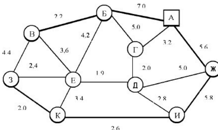
Рисунок 2.1 – Схема размещения пунктов и расстояние между ними
