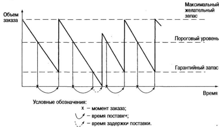
Рис. 8. Система с фиксированным размером заказа
